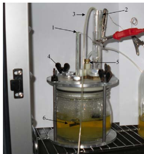
Рис. 15. Схематическое изображение и фотография биореакторной топливной ячейки: 1 - контакт ферментного электрода, 2 - кислородный электрод, 3 - воздушный шланг, 4 – мембрана для отбора проб в процессе эксперимента, 5 – система сброса избыточного давления, 6 – ферментный электрод.
